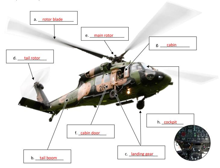
cabin // cabin door // cockpit // landing gear // main rotor // tail rotor // rotor blade // tail boom
