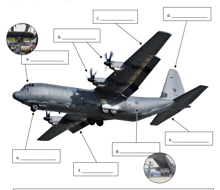
propellers // cargo bay // cockpit // landing gear // wing // vertical stabiliser // flaps // horizontal stabiliser
