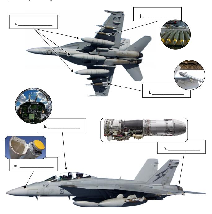
radar // external fuel tanks // cockpit // missile // jet engine // bomb
