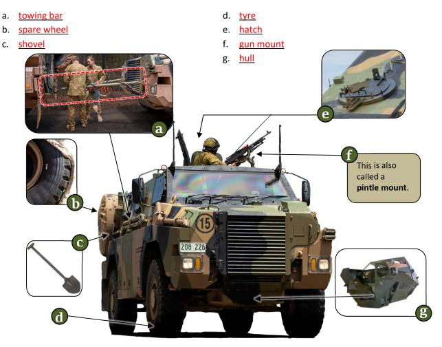
shovel // hull // towing bar // tyre // gun mount // hatch // spare wheel
